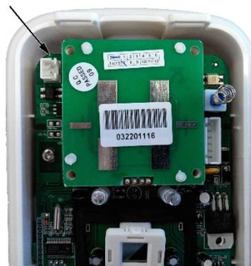
4. Brancher le connecteur de la batterie sur le bornier BAT1 situé en bas à gauche du circuit imprimé, le détecteur FT-89RS s'initialise durant 3 minutes ;
