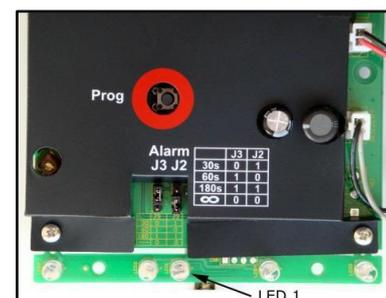
**NB :** En fonctionnement normal, la LED 1 clignote à intervalle régulier. Si elle ne clignote plus ou que la sirène émet des bips réguliers toutes les 30 secondes, procéder à un changement de piles « Cf. Remplacement des piles ».
